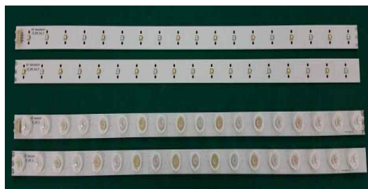
그림 4. LED 모듈과 렌즈 구조 Fig. 4. LED module and lens structure
